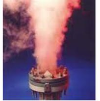
La protection des installations sous pression et la sécurité du personnel industriel est un sujet de préoccupation pour la gestion des exigences techniques et sécuritaires. L'utilisation de disques de rupture constitue à cet effet une solution efficace et économique.
